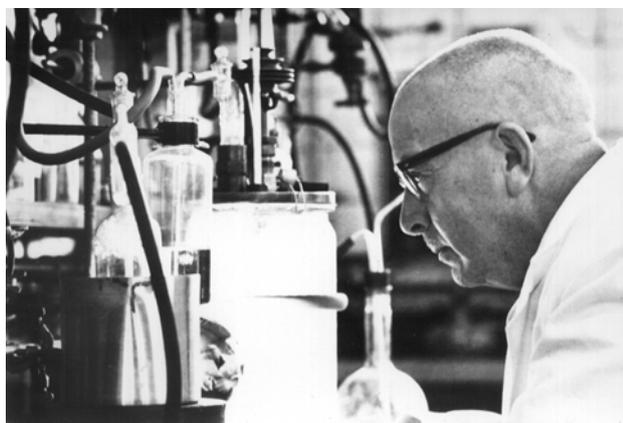
Die „Ziegler-Polymerisation“ im Laborversuch: Das Weckglas ist mit schneeweißem Polyethylen gefüllt.
