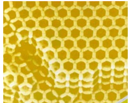
Abb. 1: Ein inverser Opal aus \text{TiO}_2 mit Skelett-Morphologie
