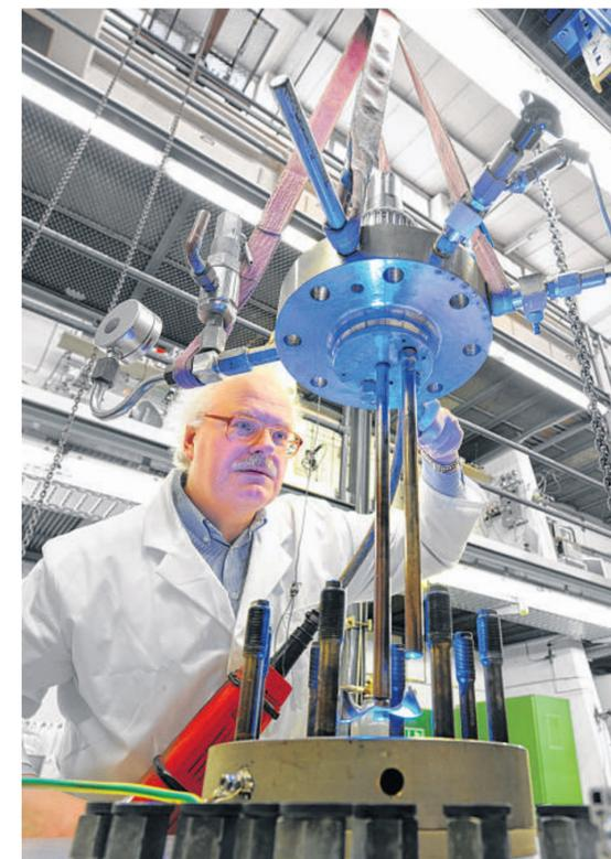
So sieht moderne Wissenschaft aus: Unser Bild zeigt Techniker Udo Richter aus der Abteilung für Heterogene Katalyse an einem Autoklaven, in dem aus Holz das begehrte Lignin gewonnen wird.
